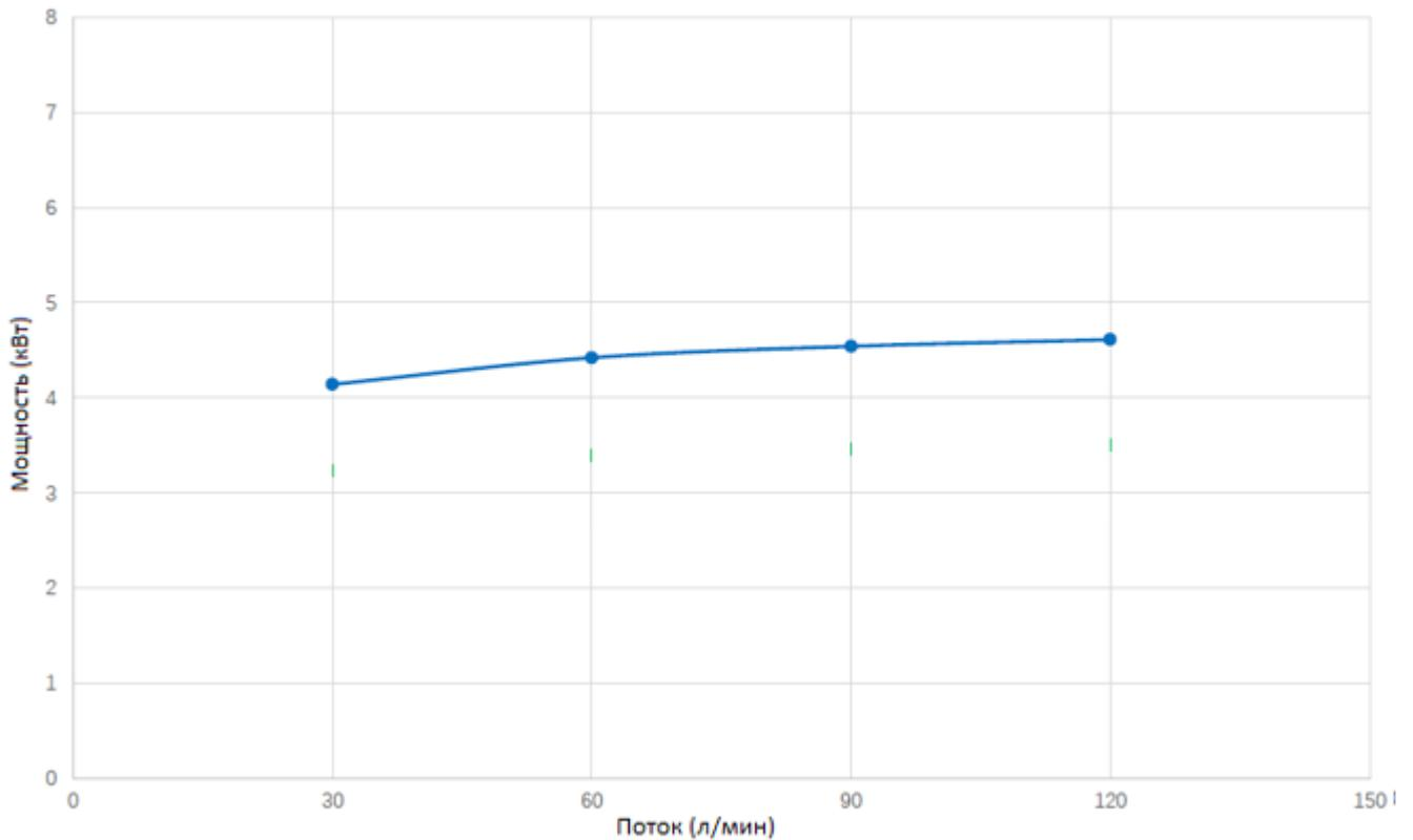
Рис. 2. Производительность маслоохладителя АН-Т11-В-24С при перепаде температуры 20°С
