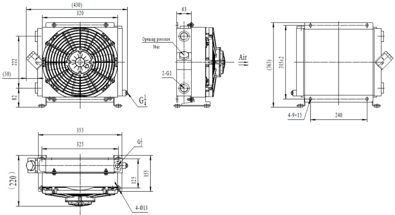
Рис. 1. Габаритные и присоединительные размеры АН-Т11-В-24С
