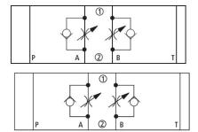
Регулирование расхода на выходе
